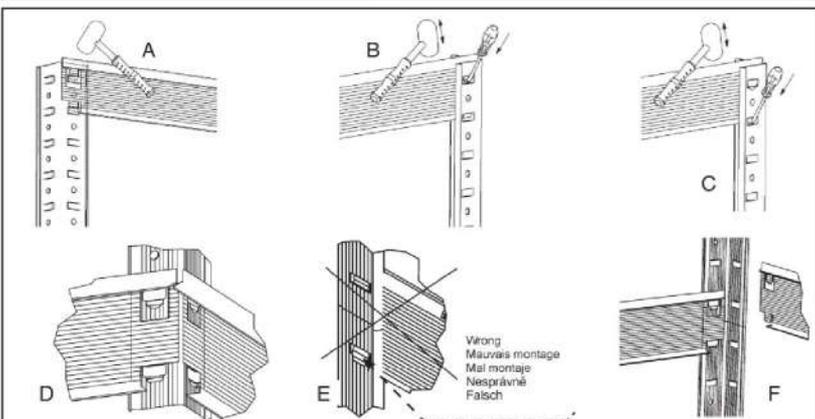
1. Montáž regálu se provádí zdola nahoru. Police (4) musí být vkládány po smontování čtyř nosných prvků police (2, 3) a středového nosníku (5).
